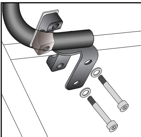
**3** Befestigung des Tankschutzbügels links und rechts unten:
