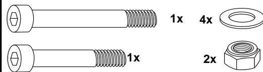
Verkleidung wieder montieren. Zwischen Verkleidung und Rahmen die U-Scheiben Ø6,4x3mm fügen.
