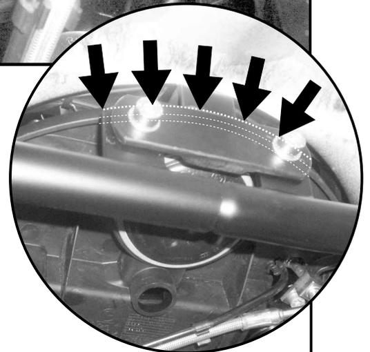
**Durch Toleranzen am Fahrzeug kann es notwendig sein, die Verkleidung an der markierten Zone nachzuarbeiten.**
