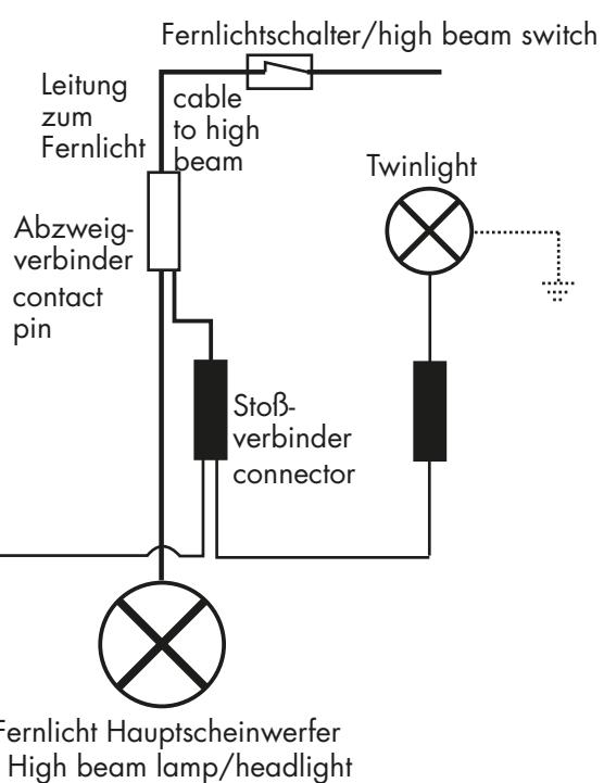
Bei beschichteten Twinlighthaltern muss eine separate Masseverbindung zum Fahrzeug hergestellt werden!
