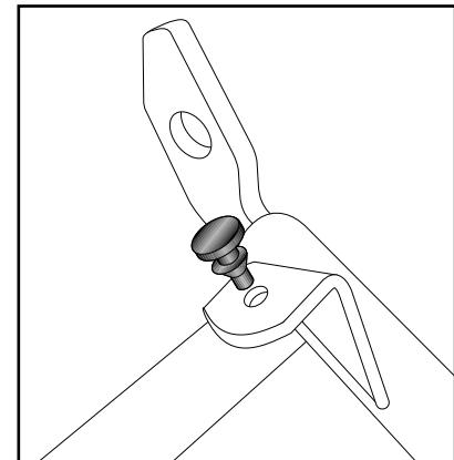
**Montage des Halters mit Hauptständer links und rechts:**
