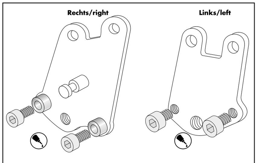
Die Original Schleifpins der Fußrasten rechts und links entfernen und die mitgelieferten Schleifpins SW10 montieren.
