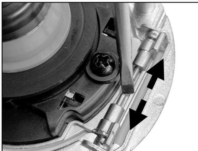
Die Kunststoffabdeckung wieder mit den originalen Kreuzschlitzschrauben montieren.
