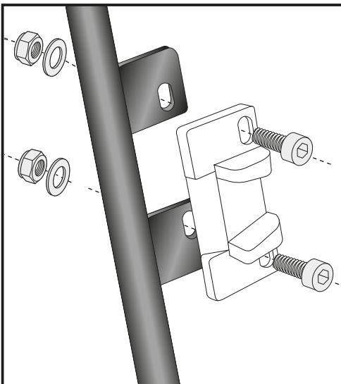
Montage des Metalladapters zum Einhaken des Kofferhalteschlosses
