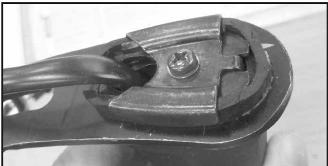
Nun den originalen Reflektorenhalter durch den mitgelieferten Halteadapter oben hinten ersetzen und diesen samt Kennzeichenhalter wieder verschrauben.
