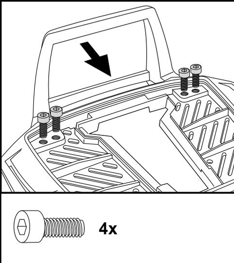
**5** Nur beim Alurack notwendig ! Easyrack weiter mit Schritt 6:
