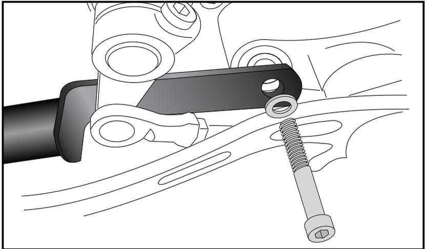
Montage des Motorschutzbügels links oben:
