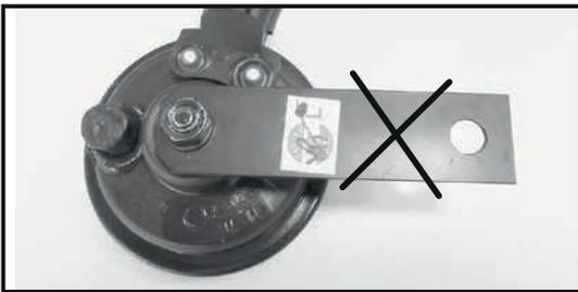
Die Hupe demontieren, das Halteblech entfernen, dieses entfällt und wird durch mitgelieferte Hupenhalterung ersetzt. Die beiden Originalschrauben rechts und links unter dem Cockpit entfernen, diese entfallen.
