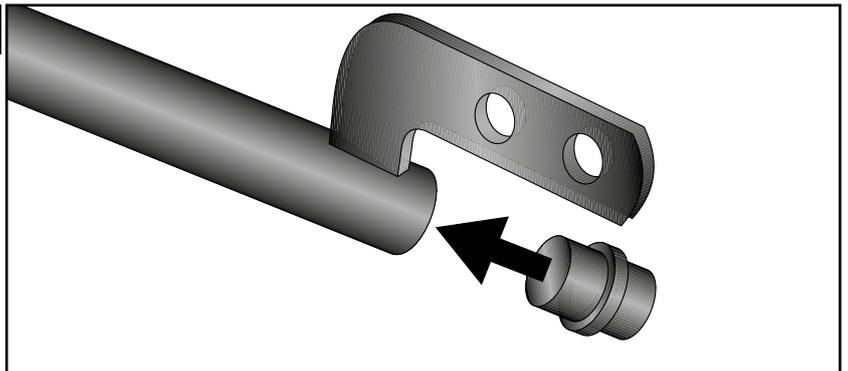
**Montage Motorschutzbügel hinten rechts:**
