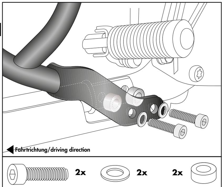
**Montage Motorschutzbügel links oben:**
