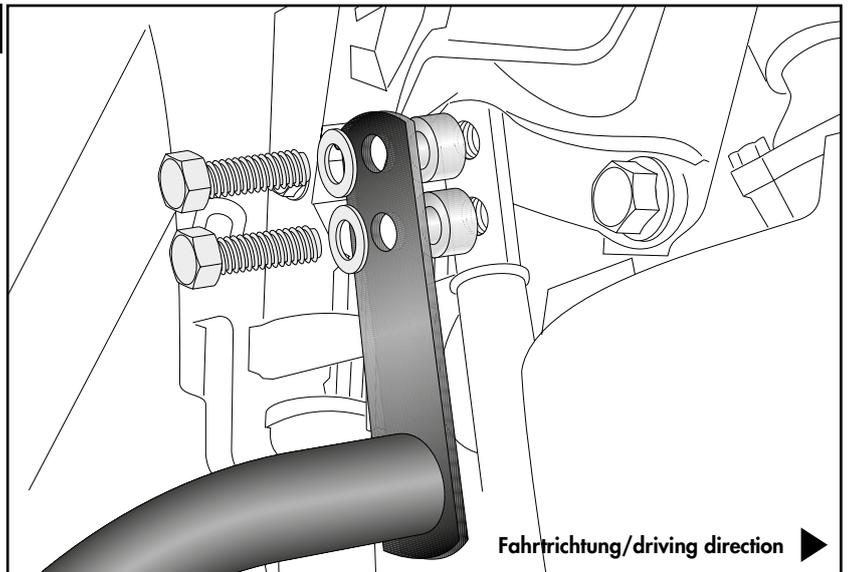
Die beiden Bügelhälften vorne mit Sechskantschrauben M6x16, Karoseriescheiben Ø6,4x18 und selbstsichernden Muttern M6 verschrauben.
