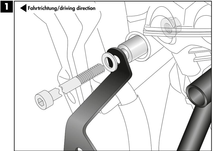
Verbindungsstopfen Ø25mm vorne in das Rohr des linken Schutzbügels einsetzen.
