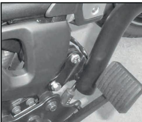
**5** Montage des Motorschutzbügels rechts unten:
