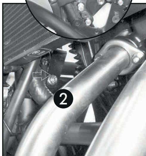
**2** Montage des Motorschutzbügels links mitte:
