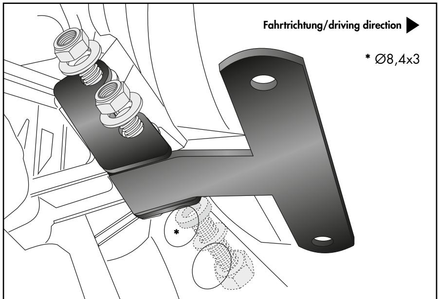
**Tankschutzbügel rechts hinten:**
