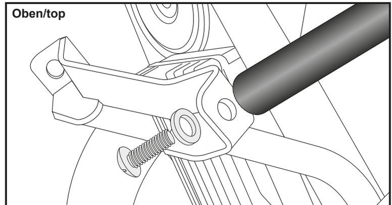
Montage Motorschutzbügel rechts unten:
