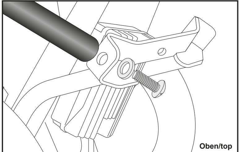
Sollte die Hupe am Haltebügel anliegen, kann sie mit der Linsenkopfschraube M6x20, U- Scheiben Ø6,4 und selbstsichernder Mutter M6 an diesem verschraubt werden (Bild).
