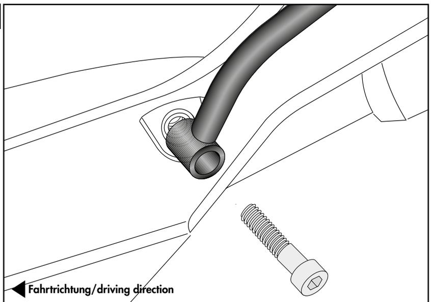
**Montage der Rohradapter rechts/links hinten:**
