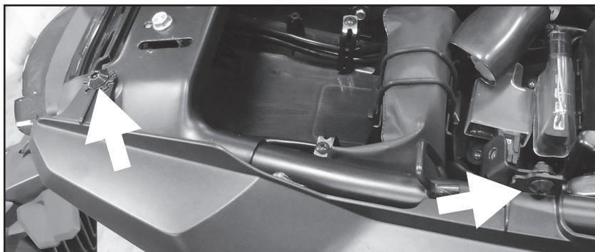
Die 2 Haltepins der Verkleidungen auf der Unterseite entfernen und die Verkleidung komplett demontieren.
