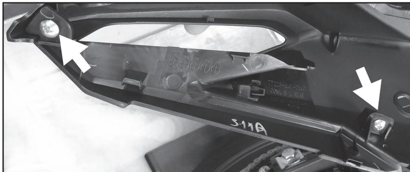
Nun die Sechskantschrauben der Kennzeichenhalterung entfernen, diese entfallen.
